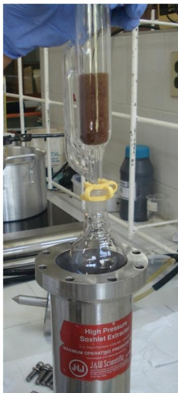
**Figura 12:** Fotografía del extractor Soxhlet de altas presiones.
