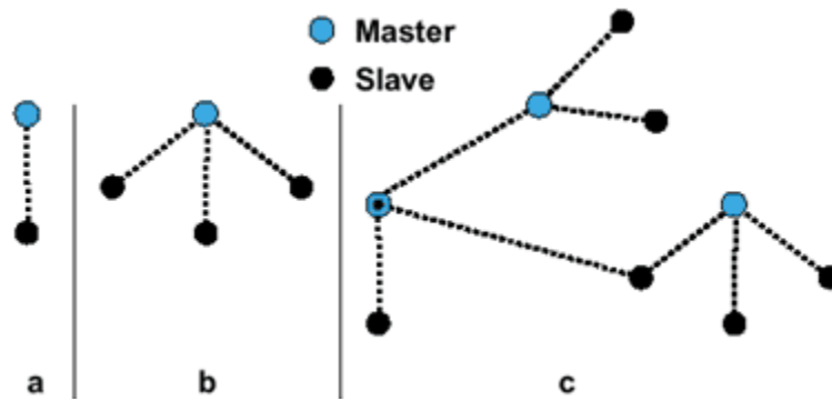
(Figura N° 21) Piconet con un solo esclavo (a), con múltiples esclavos (b) y scatternet" (c)
