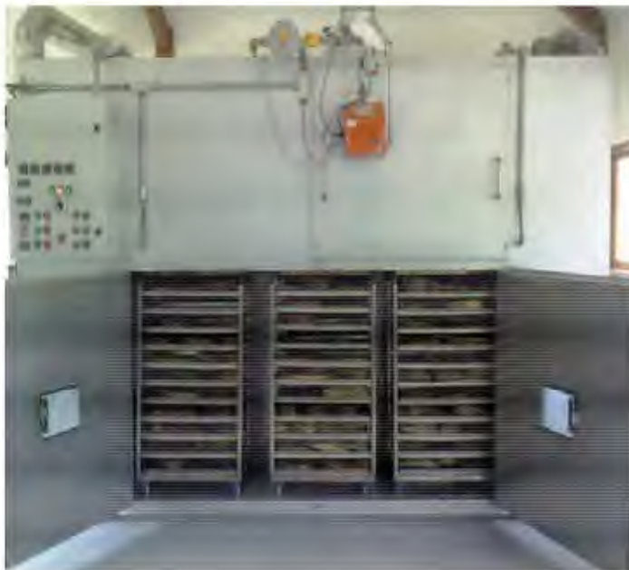
Figura 20 : Horno de secado cargado con los 6 carros.
