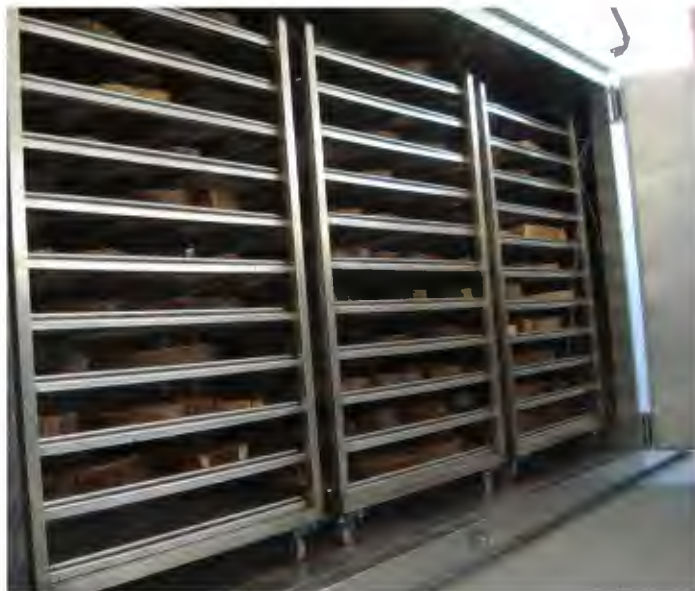
Figura 21 Secador de horno con carros portabandejas y muestras listas para su secado.
