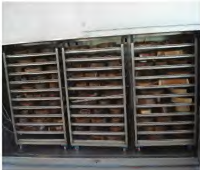
Figura 20 Secador de horno con carros portabandejas y muestras listas para su secado.
