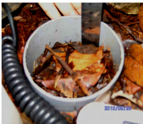
Figura 12 Medición de la profundidad del tubo
