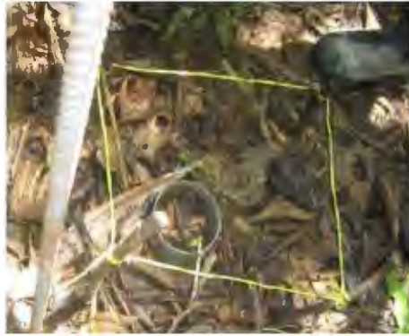
Figura 9 Instalación del tubo de medición de flujo de CO 2 .
