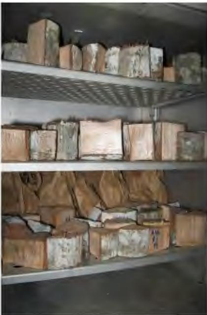
**Figura 25** Secado de las probetas de fustes en el Laboratorio de Pulpa y Papel de la FCF-UNALM
