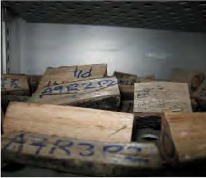
**Figura 24** Secado de las probetas pares de ramas en el Laboratorio de Pulpa y Papel de la FCF-UNALM
