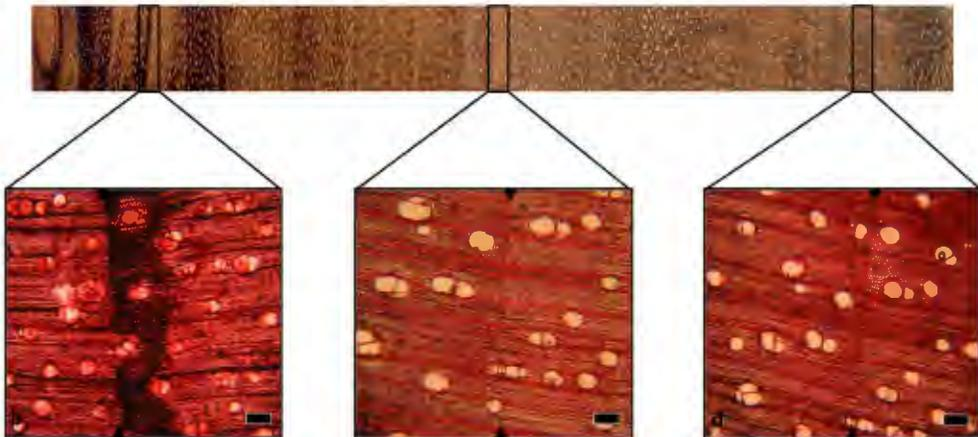
**Figura 30** Imagen microscópica de los anillos de crecimiento en el leño de la especie *Loxopterygium huansango*. a) Serie de anillos medula-corteza. b), c), d) variabilidad de anillos de crecimiento anchos y estrechos (40x). Barra= 100  $\mu$
