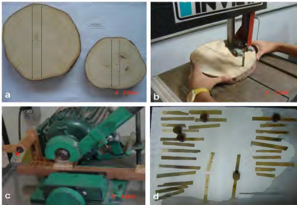
**Figura 24** Obtención de muestras para densitometría de Rayos X. a) marcado de radios en la sección transversal de los discos, (b) corte de radios marcados (2 por muestra) medula-corteza, c) radios cortados en sección transversal colados sobre soportes para su posterior corte con sierra doble y d) muestras de radios cortados a un espesor de 2 mm listos a ser irradiados
