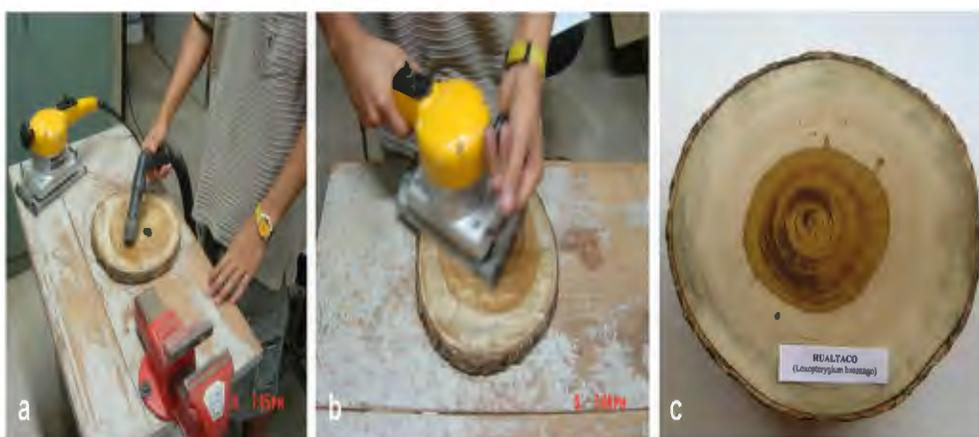
**Figura 20** Lijado y pulido de discos a) Limpieza de la superficie transversal del disco para lijado, (b) Lijado con graduación de aspereza variando de 100-600 (c) producto final, se aprecia el resalte de anillos de crecimiento producto del acabado manual
