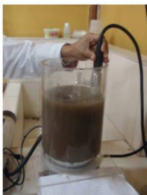
Figura 24. Dispositivo de calibración de turbiedad en laboratorio
