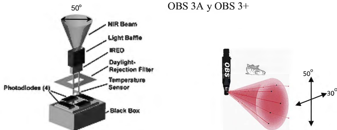
Figura 4. Principio de medida sonda OBS 3A y 3+ Fuente: d-a-instruments
