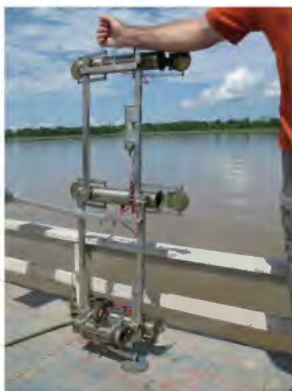
Figura15. Muestreador triple (20, 50 y 100 cm desde el fondo)
