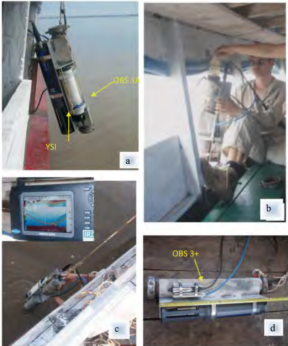
Figura 22. Montaje y puesta en operación sondas de turbiedad.
