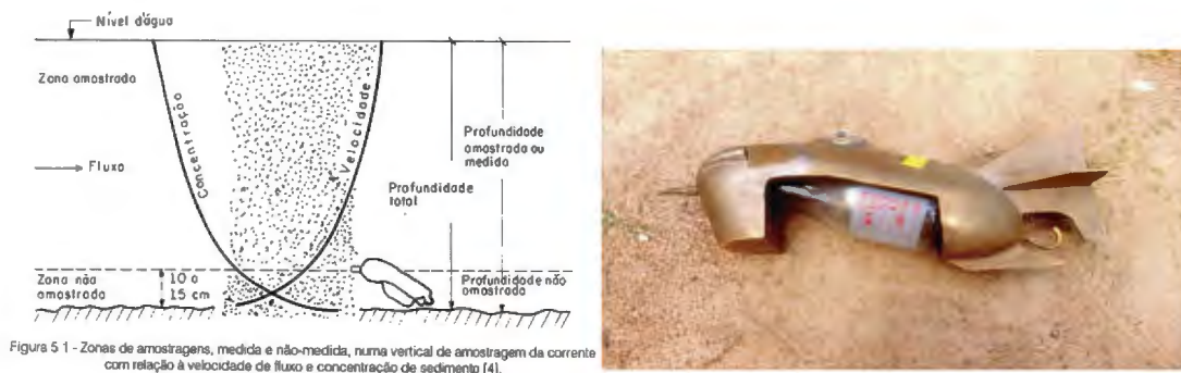
Figura 12. Aforo sólido Muestreo integrado de agua y sedimentos. (Fuente.- Proyecto Hybam)
