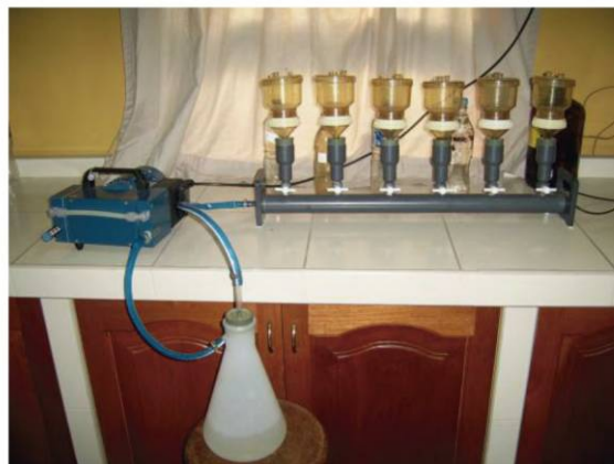
Figura 23. Bomba de vacío, rampa de filtración.
