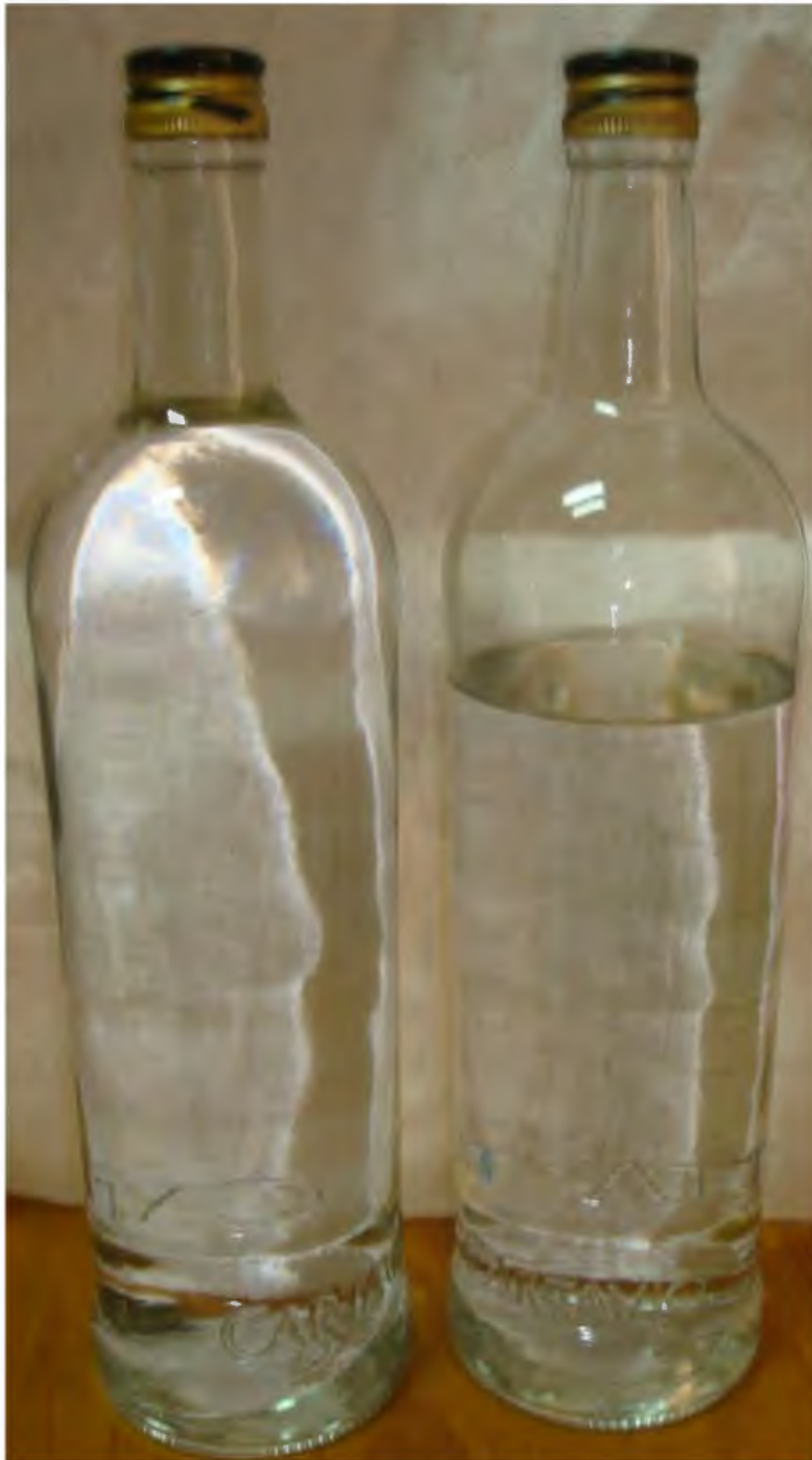
Figura 9: Botella de 1L completamente llena de producto (sin aireación) lado izquierdo y botella de 1L llena de producto hasta sus \frac{3}{4} partes-750 ml del volumen total (con aireación) lado derecho
