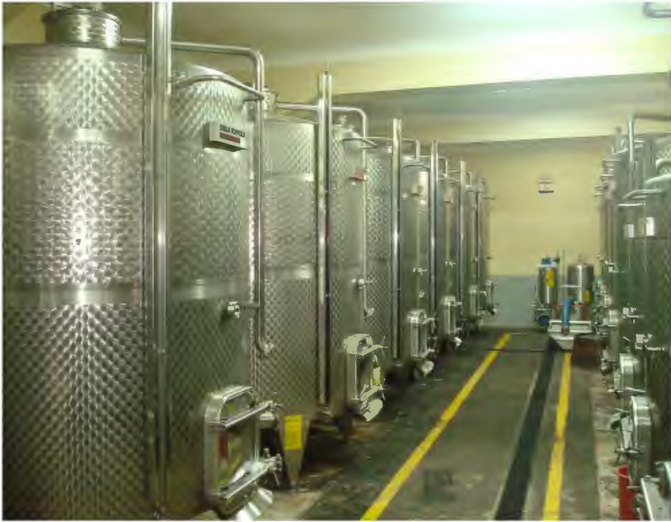
Figura 4: Tanques de acero inoxidable de 5000 L
