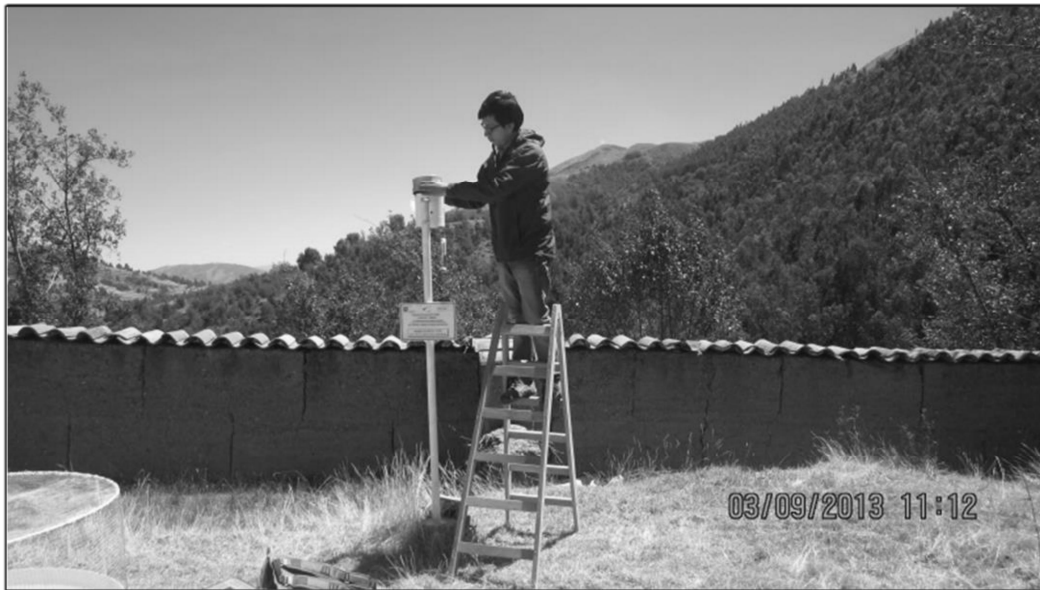
Foto 4: Procedimiento de descarga de datos, estación pluviométrica Colpar
