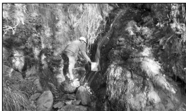
Figura 25: Proceso de aforo volumétrica, inventario de la cuenca Anya FUENTE: Elaboración propia
