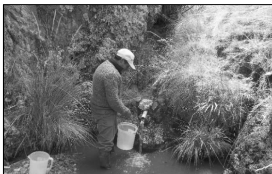
Figura 24: Proceso de aforo volumétrico, inventario de la cuenca Anya FUENTE: Elaboración propia
