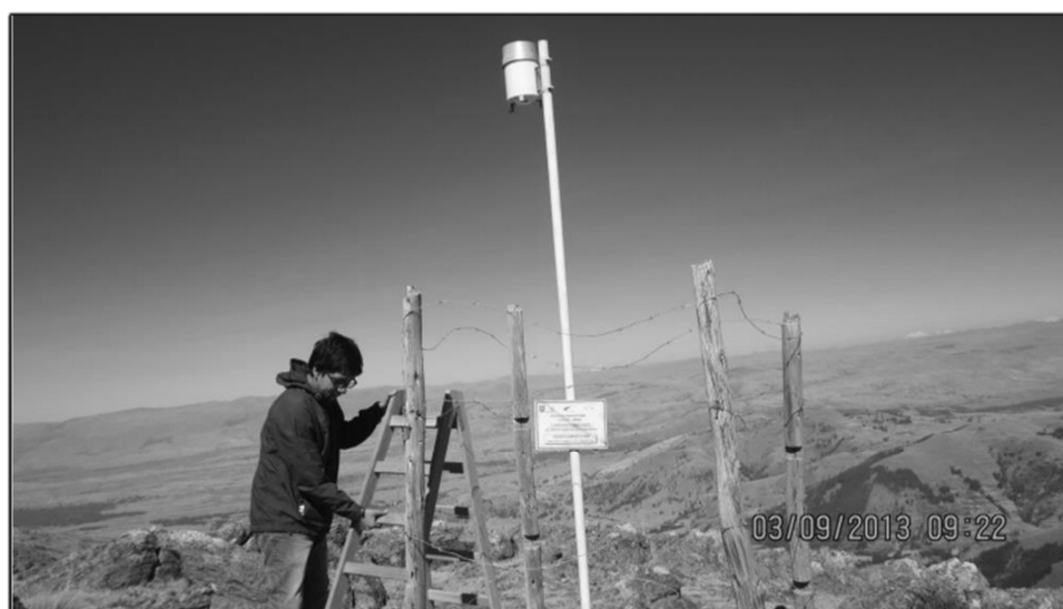
Foto 3: Procedimiento de descarga de datos, estación pluviométrica Tambo
