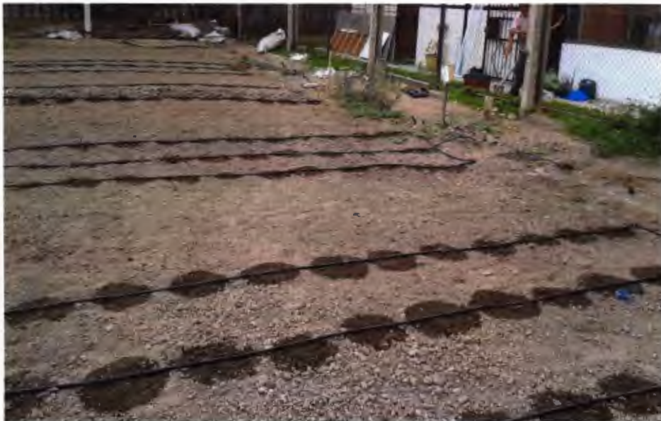
Figura N° 36: Prueba del bulbo de humedad en el área experimental
