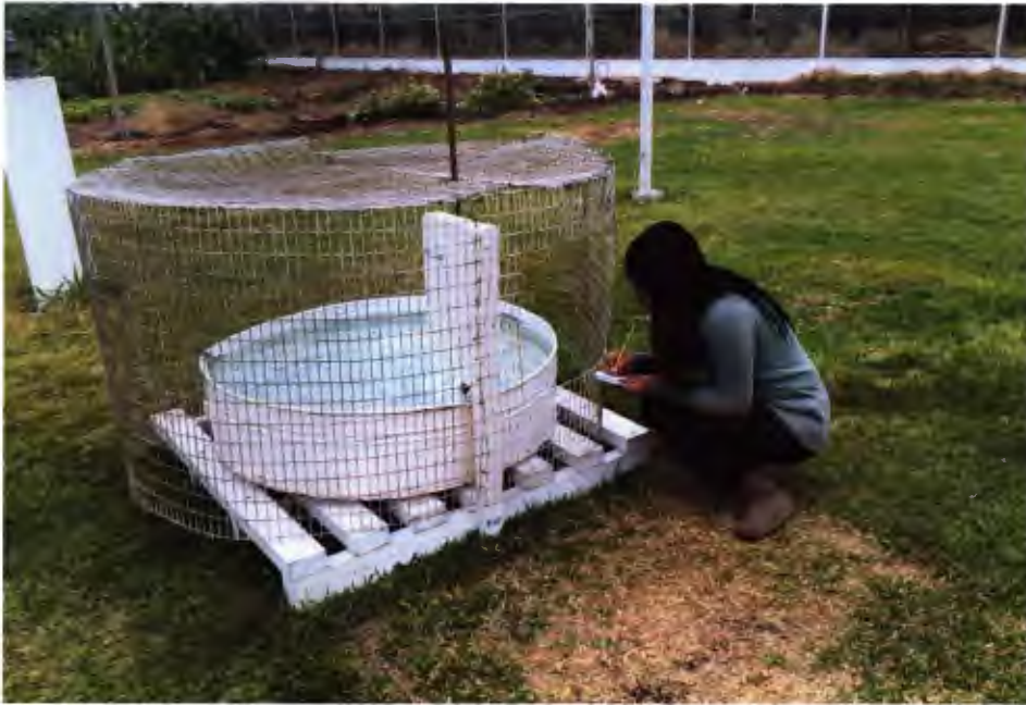
Figura N° 40: Lectura de la lámina del tanque evaporímetro tipo A
