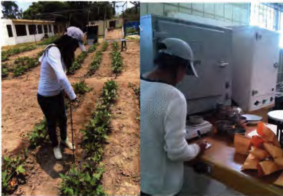
Figura N° 44: Extracción de muestras para la obtención de la humedad gravimétrica
