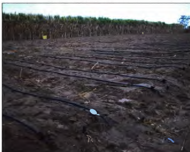
Figura N°11: Pruebas de campo en suelo arenoso para 2 horas de riego con caudal 1,2 l/h
