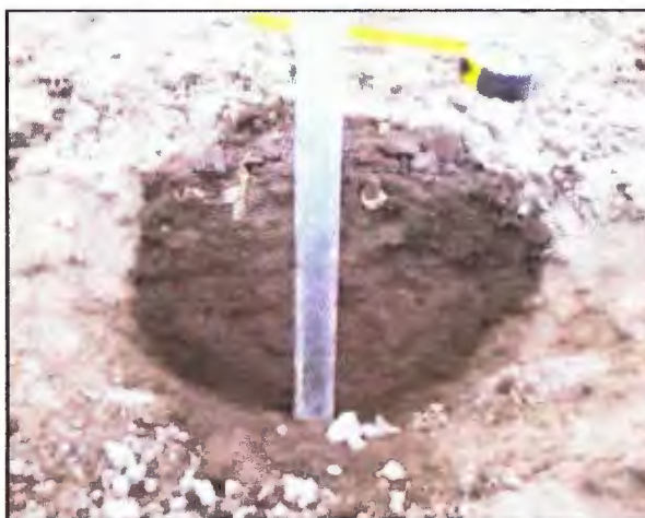
Figura N°10: Perfil del suelo franco para 2 horas de riego, con caudal 1,6 l/h
