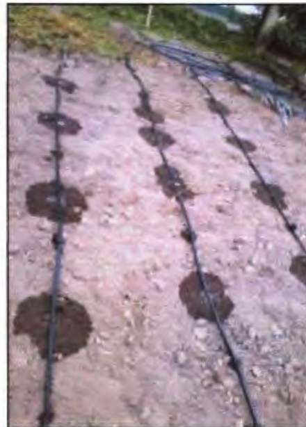
Figura N°09: Pruebas de campo en suelo franco para 2 horas de riego con caudal 1,1 l/h
