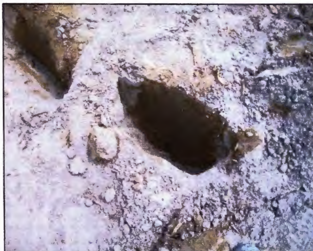
Figura N°12 Perfil del suelo arenoso para 2 horas de riego con caudal 1,6 l/h
