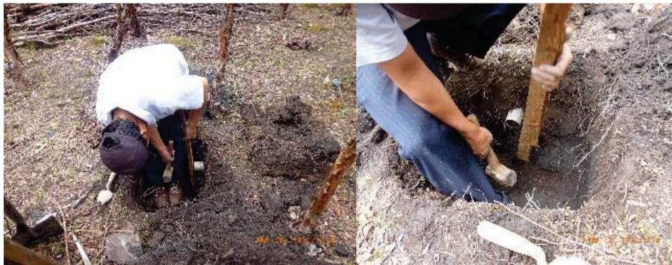
Figura 33: **Toma de muestra mediante el uso del cilindro metálico.**
