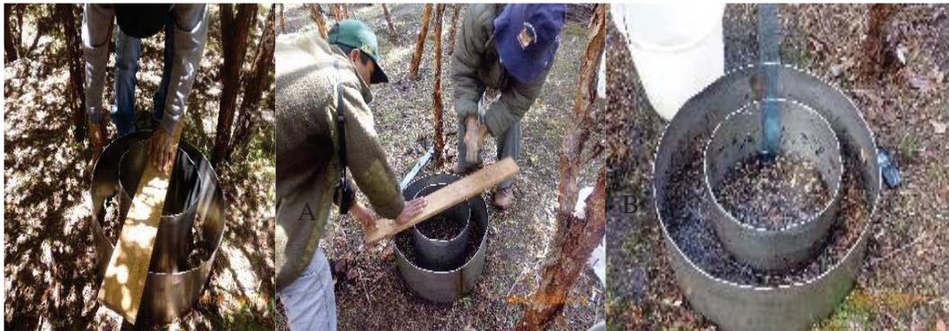
Figura 30: **A) Instalación de los cilindros B) Instalación de la regla graduada.**
