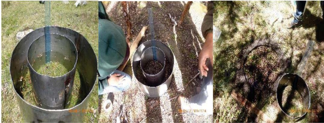
Figura 32: A) Toma de medida del descenso de agua B) Retiro de los cilindros infiltrómetros.
