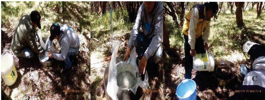
Figura 31: **A) Instalación de plástico B) Llenado de agua en el cilindro de menor diámetro C) Llenado de agua en cilindro de mayor diámetro.**
