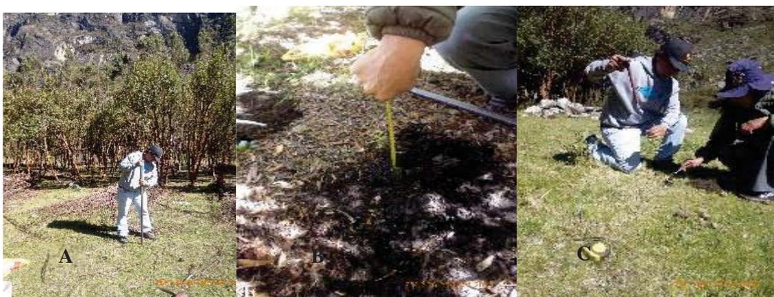
Figura 26: A) Formación de hoyos B) Profundidad del hoyo C) Instalación de los bloques de yeso.
