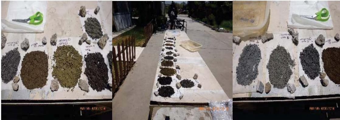
Figura 23: Secado de muestras de suelo para la identificación del color.
