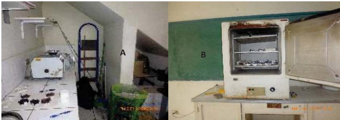
Figura 25: A) Peso de muestras de hojarasca B) Secado de muestras, por 75 horas.
