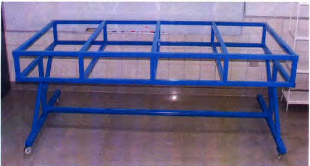
Foto N° 02: Estructura de soporte del Banco de Pruebas.
