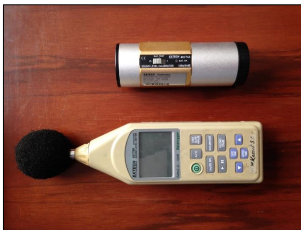
Figura 32: Sonómetro EXTECH Instruments 407780 y calibrador acústico EXTECH Instruments 407744
