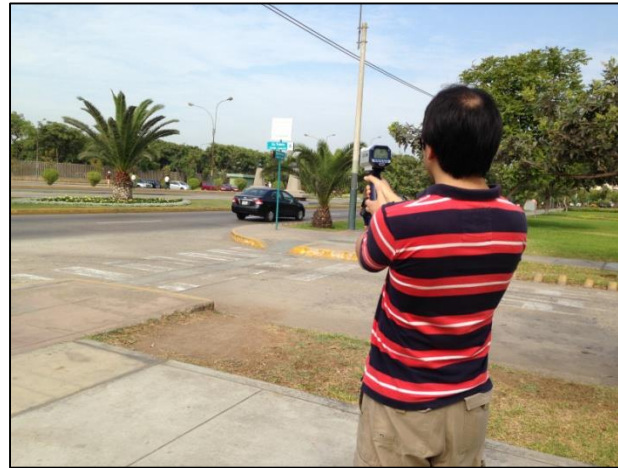
Figura 26: Medición de velocidad en la estación EST-01 (Av. San Borja Norte)
