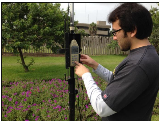
Figura 33: Configuración del sonómetro EXTECH Instruments 407780
