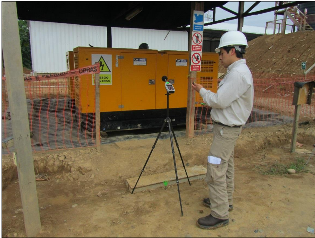
Fotografía 01 – Reconocimiento con GPS de estación de medición de ruido
