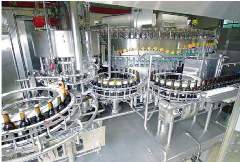
Figura 14: Envasado de cerveza con sistema de llenado automático “ Sensometric Vpvi ” FUENTE: Tomado de Hans, 2009, pág. 295.
