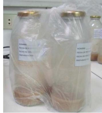
Figura 12.- Muestras siendo incubadas en la estufa, a 42.5°C, por 8, 10 y 12 horas.
