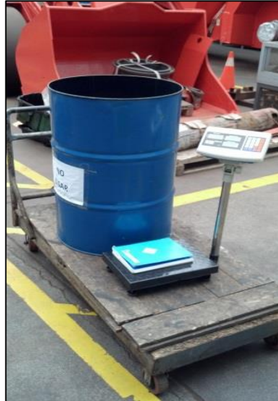
Foto N° 5. Cilindro y balanza utilizados para el estudio de caracterización.
