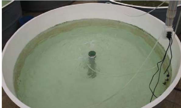
Figura 18: Bioreactor con tecnología biofloc instalado (Día 1).
