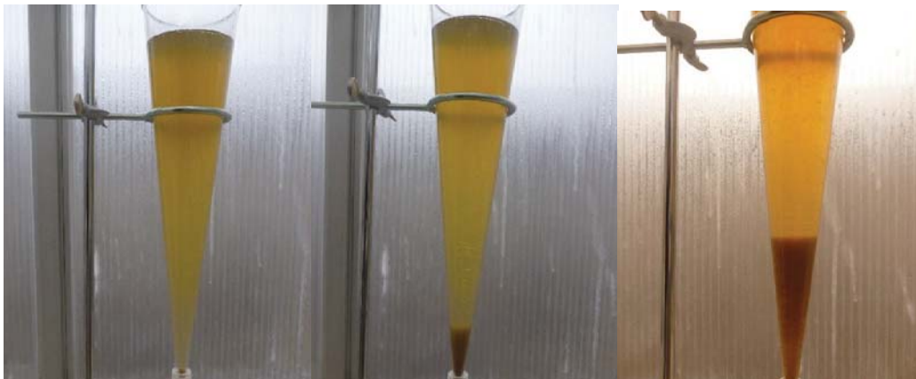
Figura 16: Incremento en la concentración de sólidos sedimentables en el bioreactor.
