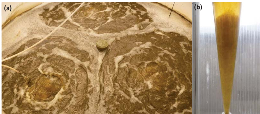
Figura 11: (a) Formación del Bulking y Foaming en el bioreactor y (b) Sedimentación lenta del biofloc en el cono imhoff.
