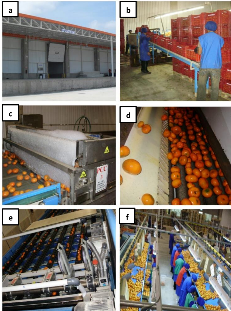
Figura 1: (a) recepción de fruta, (b) volcado de fruta, (c) lavado de fruta, (d) encerado de fruta, (e) calibración automática, (f) empaque de fruta.
