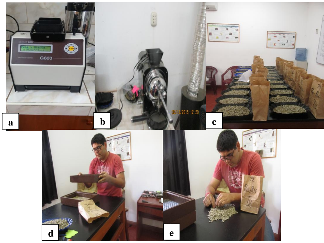
Figura 7. Prueba de calidad física en laboratorio de la Municipalidad Distrital de Villa Rica. (a) medidor de humedad, (b) trillador de café, (c) café grano de oro, (d) zarandeo de café, (e) seleccionado de granos por defecto.
