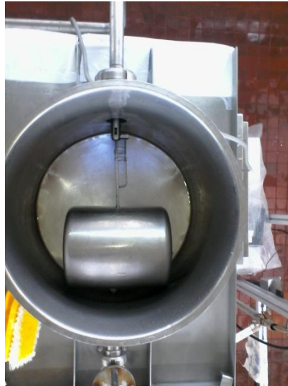
Figura 14: Control de flotación.
