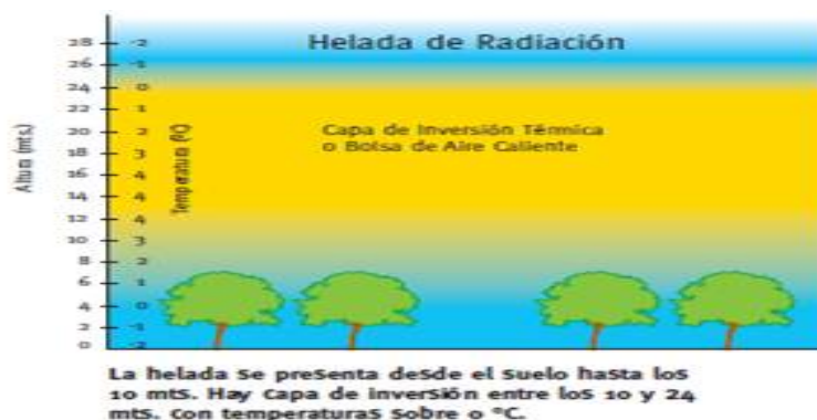
Figura 6: Helada de Radiación en donde se aprecia el proceso de inversión térmica. Fuente: Villaseca (1992).
