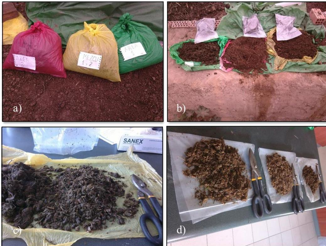
**Figura 14: Preparación de las muestras para cargar en el reactor**
