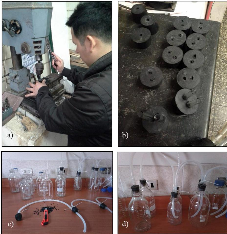
**Figura 10: Construcción del sistema de medición de biogás y metano**
