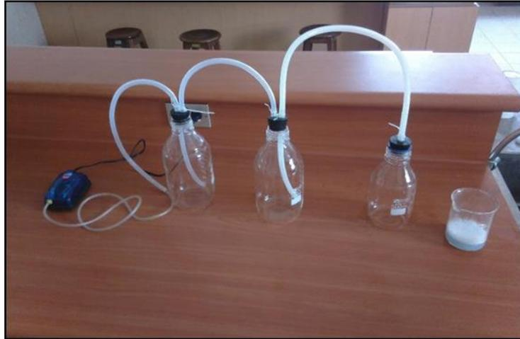
**Figura 11: Prueba hermética del reactor en el sistema de medición de biogás**
