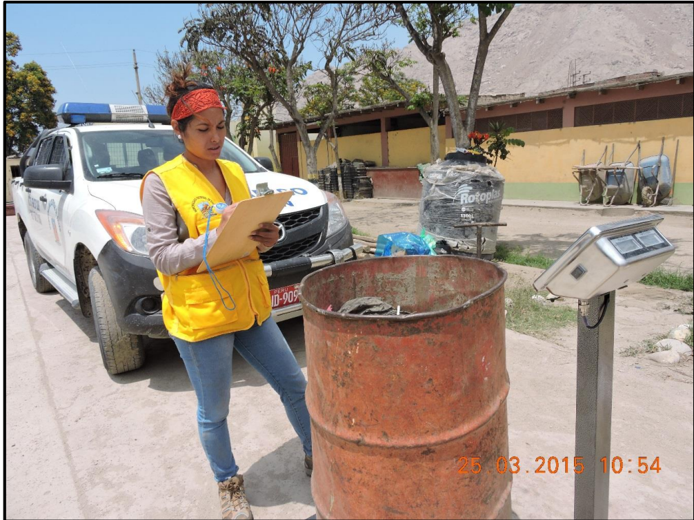
Foto 13: Caracterización: Determinación de la densidad normal.
