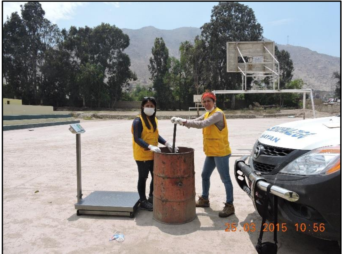
Foto 14: Caracterización: Determinación de la densidad compactada.
