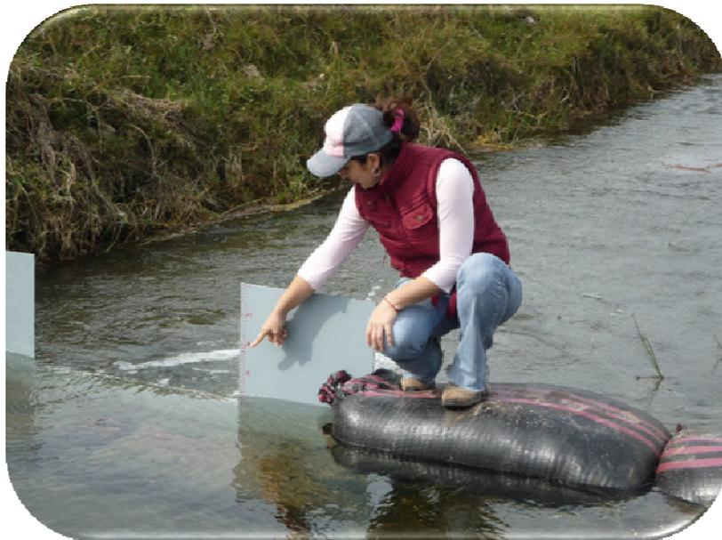
Foto N.º 24: Vertedero metálico sobre la sección del dren D-5000.
