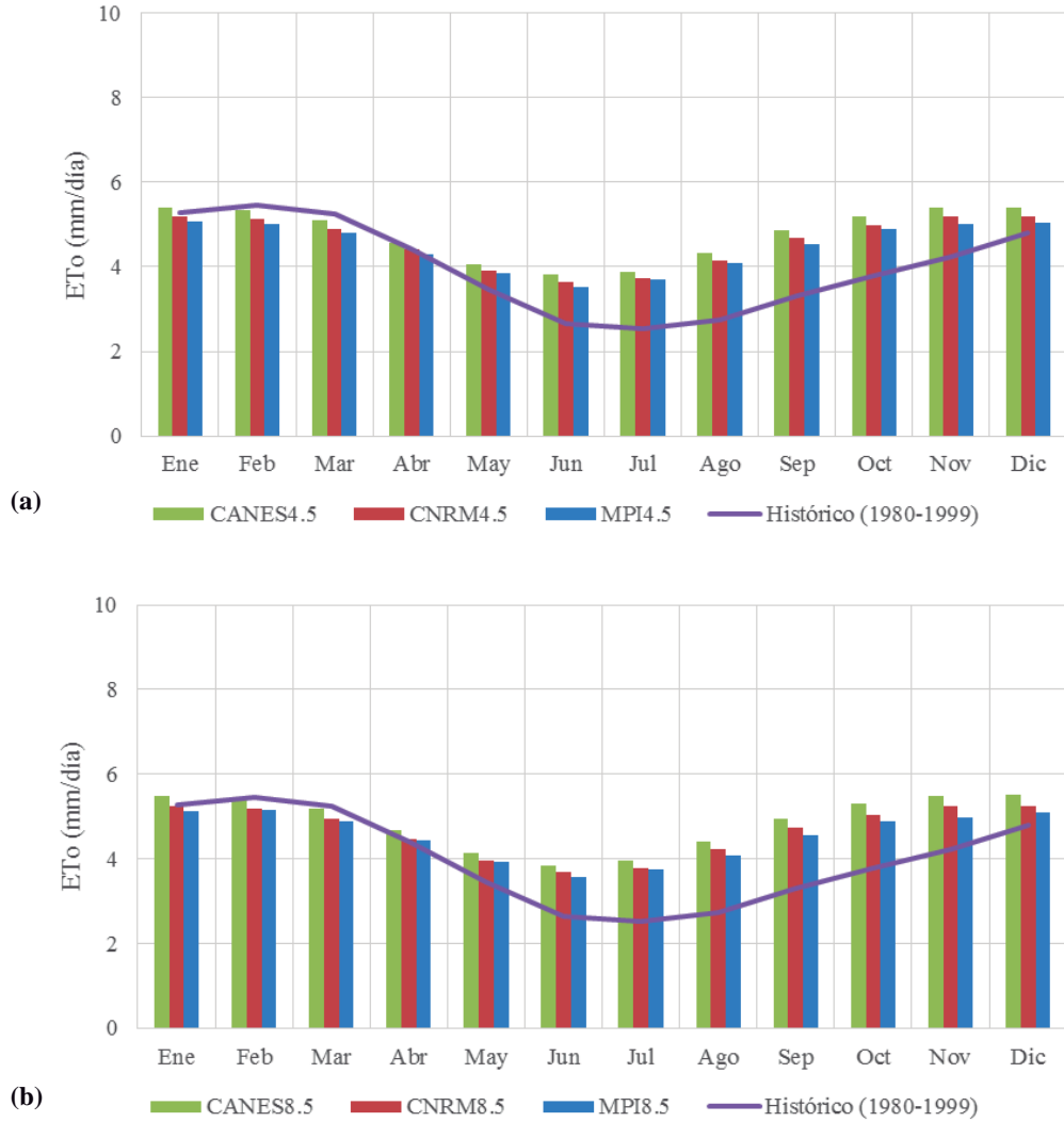
Figura 26: Diagrama de barras de la evapotranspiración de referencia de los modelos climáticos a nivel mensual en el periodo de Enero 2030 a Diciembre del 2050 en los escenarios: RCP4.5 (a) y del RCP 8.5 (b). Las líneas continuas representan la evapotranspiración mensual histórica para el periodo de Enero 1980 a Diciembre del 1999 en la Estación Von Humboldt.
