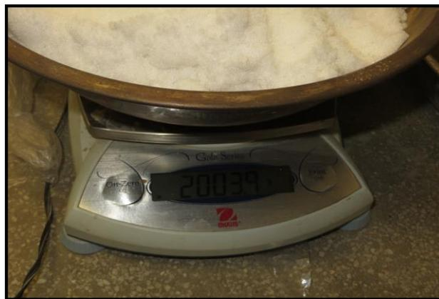
Figura 35. Peso del ácido bórico y bórax, por medio de una balanza calibrada
