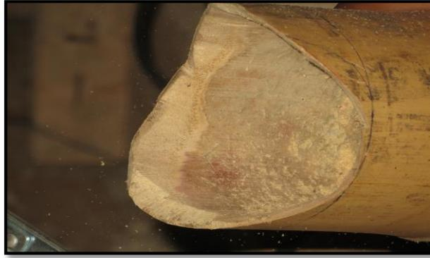
Figura 45. Boca de pescado para columna de bambú
