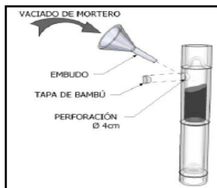
Figura 13. Unión con mortero (Fuente: Norma E100, 2012)
