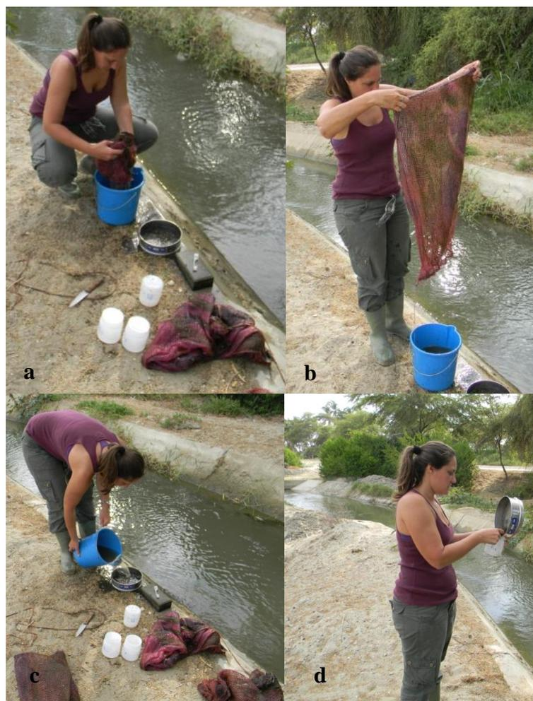
Figura 5. Muestreo de invertebrados en el campo: a y b lavado de las bolsas y el ladrillo de concreto; c, tamizado de la muestra y d, colecta y fijación de la muestra en alcohol 70°.
