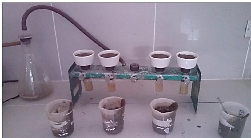
Figura N° 06: Obtención del extracto de saturación
