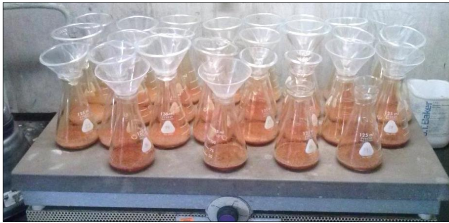
Figura N° 07: Digestión de tejido vegetal por vía húmeda para determinar calcio, magnesio, sodio y potasio
