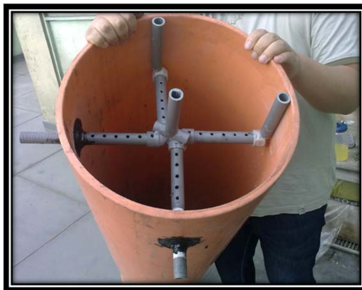
Figura 8: Vista de la base del reactor en posición invertida
