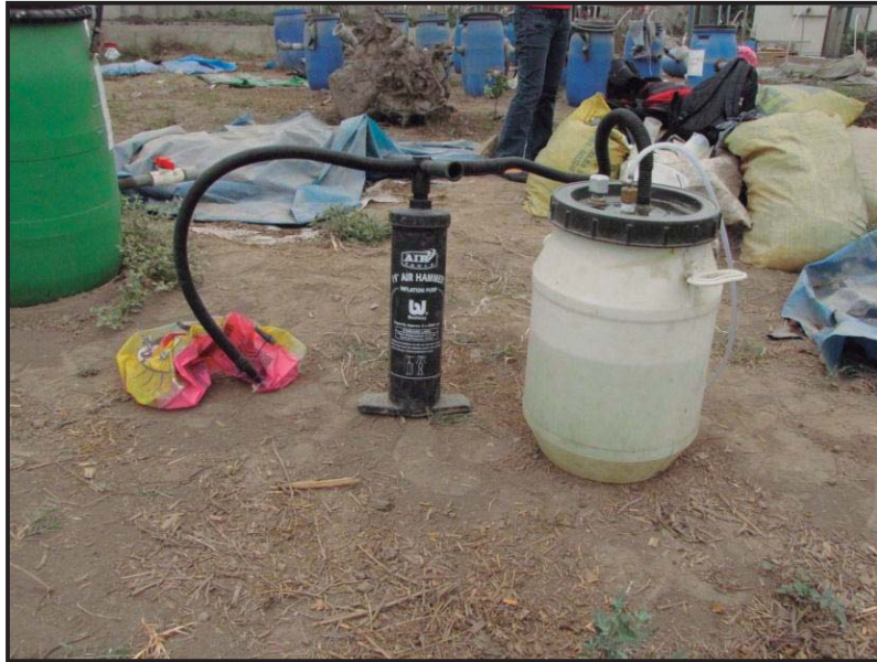
Fotografía 17. Material usado para medir el volumen de biogás generado
