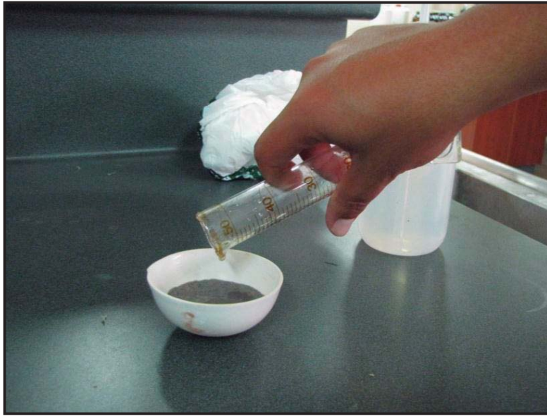
Fotografía 9. Prueba de actividad metanogénica del purín de cerdo en laboratorio de Ingeniería Ambiental, UNALM
