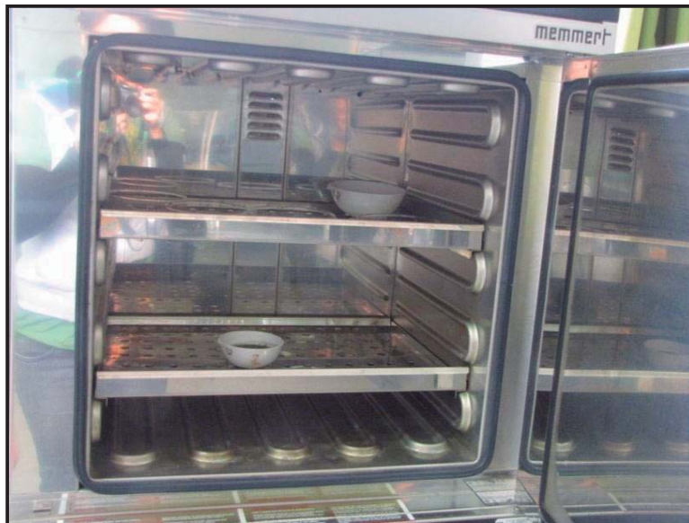
Fotografía 10. Secado del purín de cerdo para la prueba de actividad metanogénica
