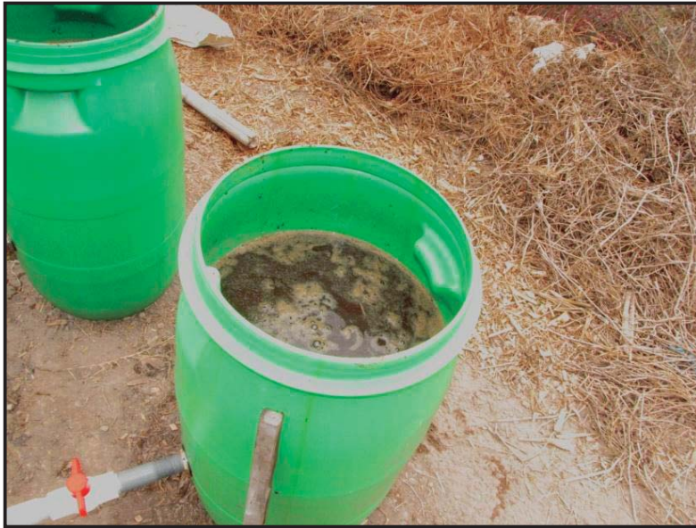
Fotografía 15. Llenado de biodigestores
