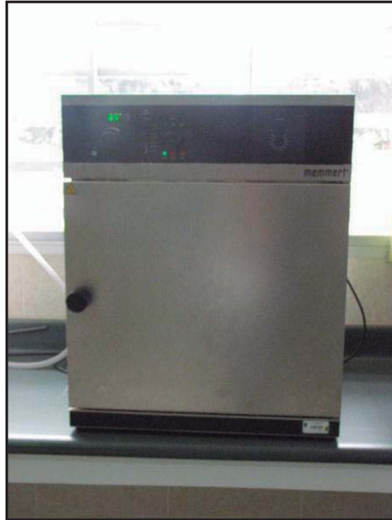
Fotografía 11. Secador utilizado para analizar la prueba de actividad metanogénica del purín de cerdo
