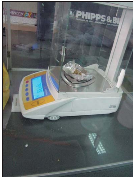
Fotografía 12. Pesado en balanza electrónica para la prueba de actividad metanogénica
