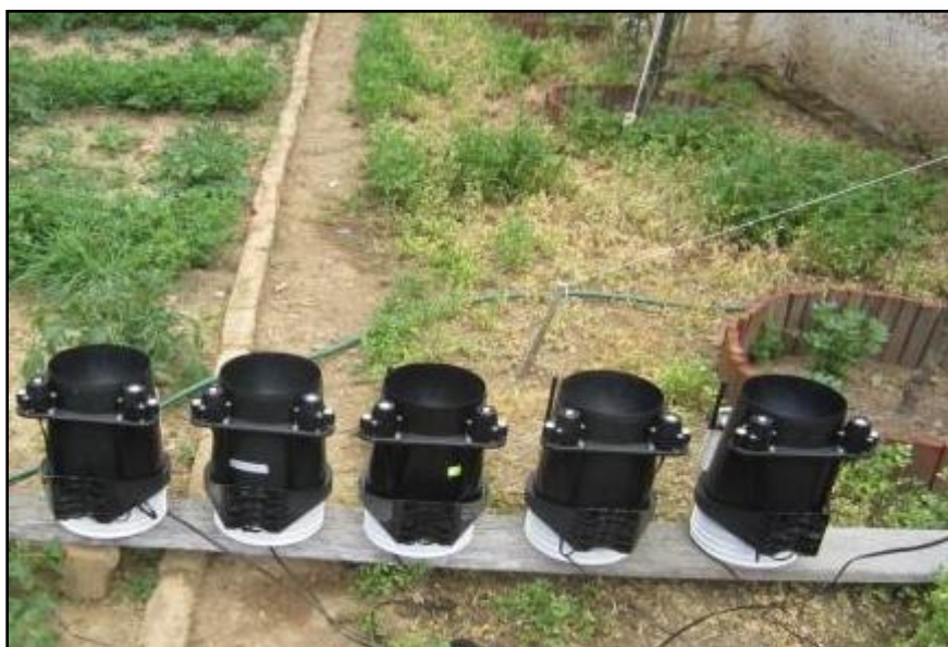
Foto 6: Calibración de las estaciones meteorológicas Davis modelo Vantage Pro2™ Plus, con una estación patrón
