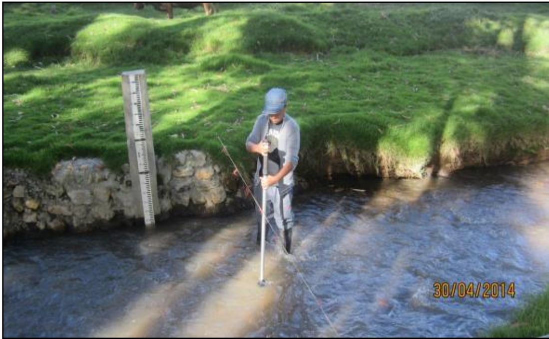
Foto 7: Procedimiento de aforo del río Anya
