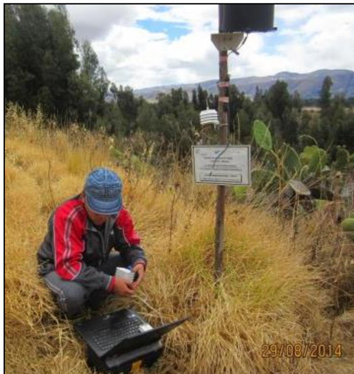
Foto 3: Procedimiento de descarga de datos de la consola de la estación meteorológica Chacrampa
