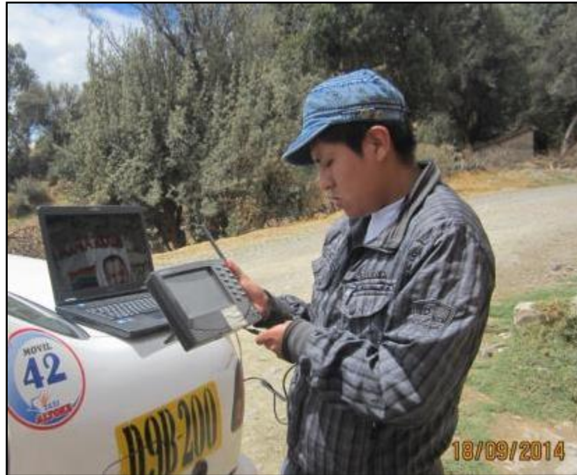
Foto 3: Procedimiento de descarga de datos de la consola de la estación meteorológica Chacrampa
