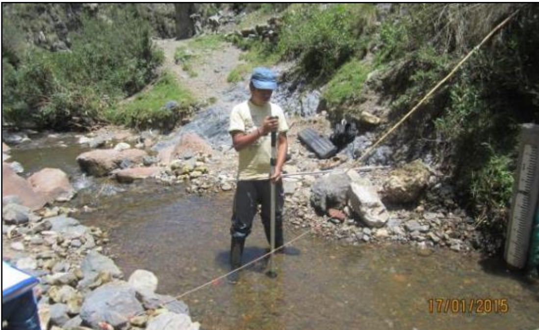
Foto 8: Procedimiento de aforo del río Mchique
