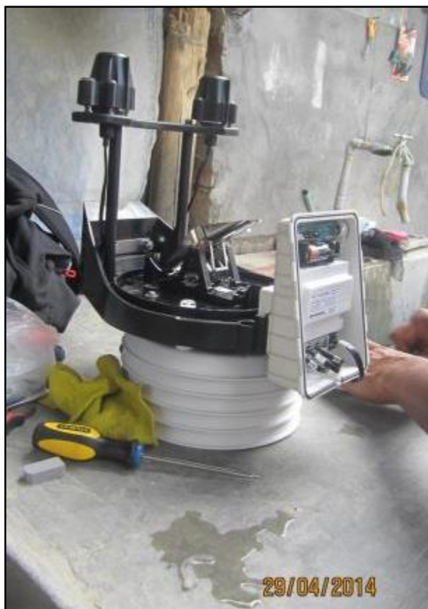
Foto 5: Mantenimiento de la estación meteorológica Davis modelo Vantage Pro2™ Plus
