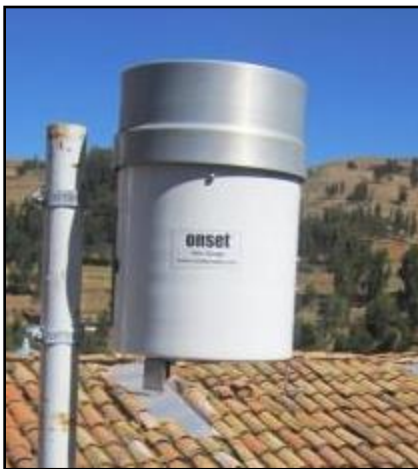
Figura 14: Estación pluviométrica RG3-M
