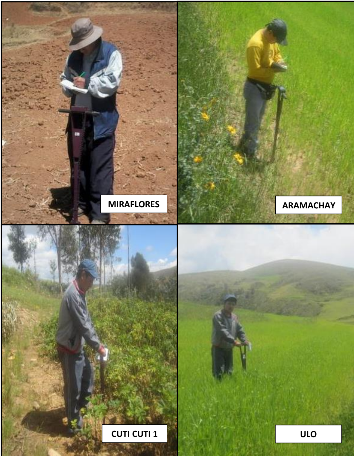
Foto 22: Medición de la humedad del suelo con el equipo TDR, en la cuenca Mchique
