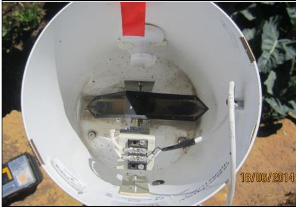
Foto 2: Mecanismo Tipping bucket del pluviómetro RG3-M
