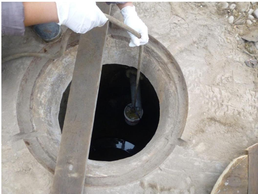
Foto N° 8: Aforo del buzón A (Método volumétrico)
