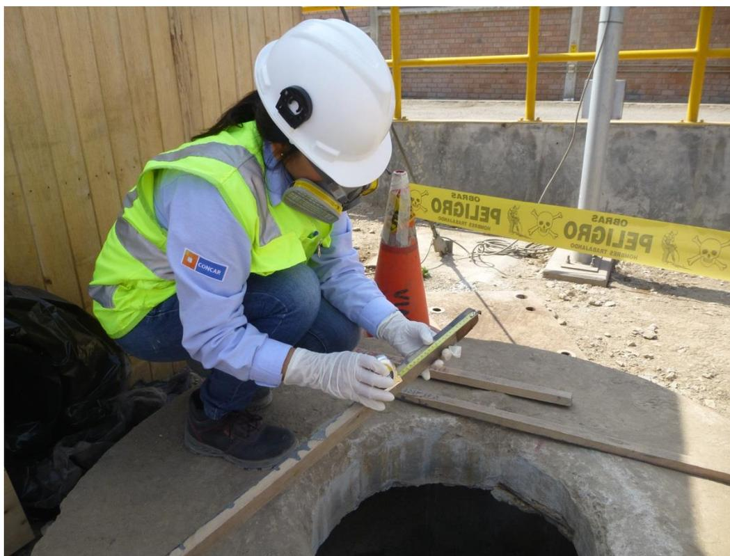
Foto N° 6: Aforo del buzón Bz 28 (método del vertedero 90°)
