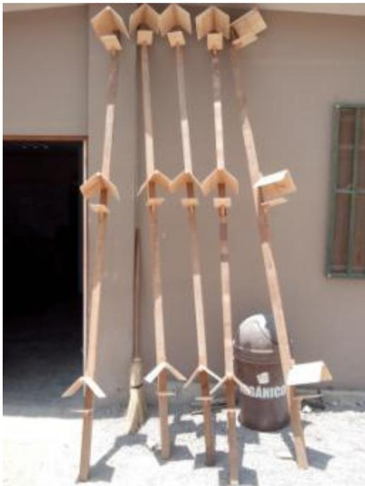
Foto N°03.- Soportes elaborados en madera para colocar las placas receptoras a diferentes alturas para la evaluación en *Schinus terebinthifolius*
