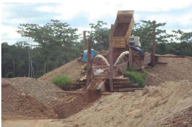
**Figura 8:** Proceso de lavado del material aluvial
