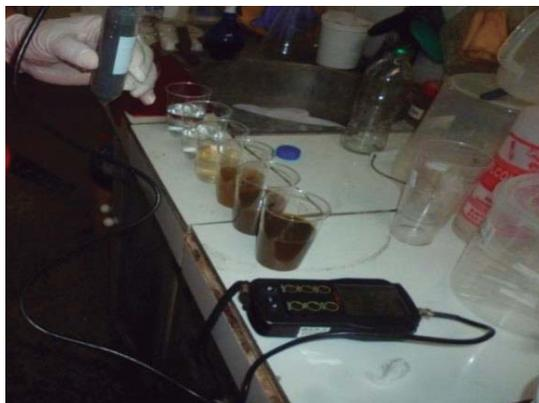
**Figura 23:** Medición de la conductividad eléctrica de las muestras
