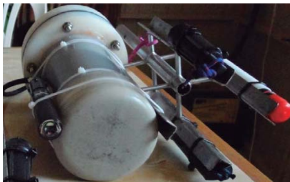
Fig. 7: Soporte de acero inoxidable con fluorómetro multionda (clorofila- a y turbidez) de seston y sensores loggers de temperatura, oxígeno y salinidad.
