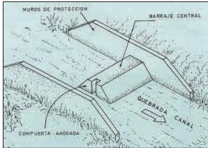
Figura N° 1: Elementos de un barraje. Fuente: Mansen H., 2013
