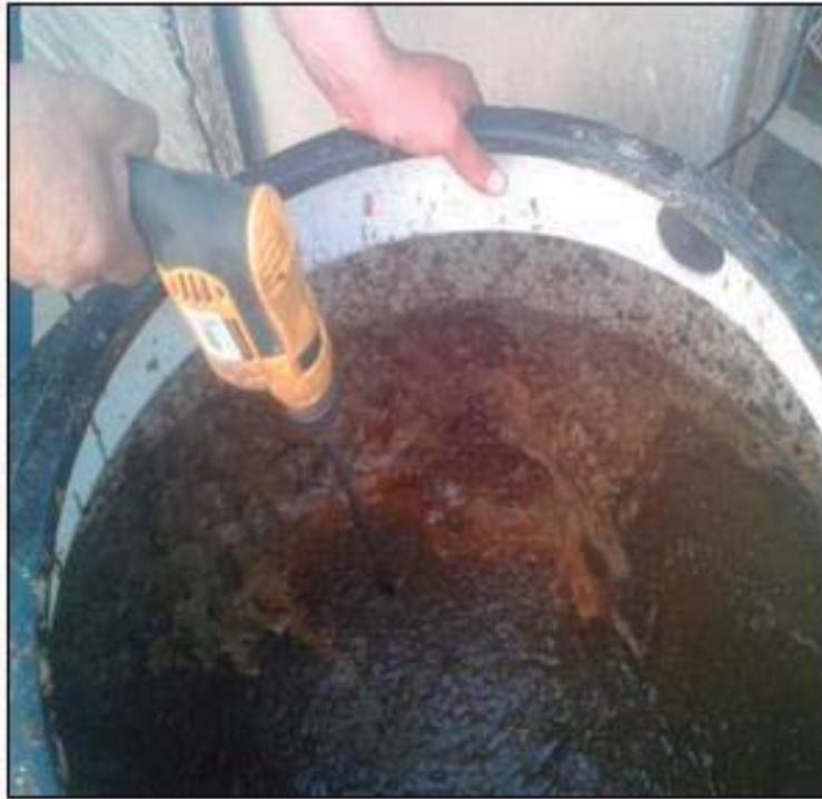
**Figura 6:** Mezcla de los insumos utilizando un taladro mecánico.
