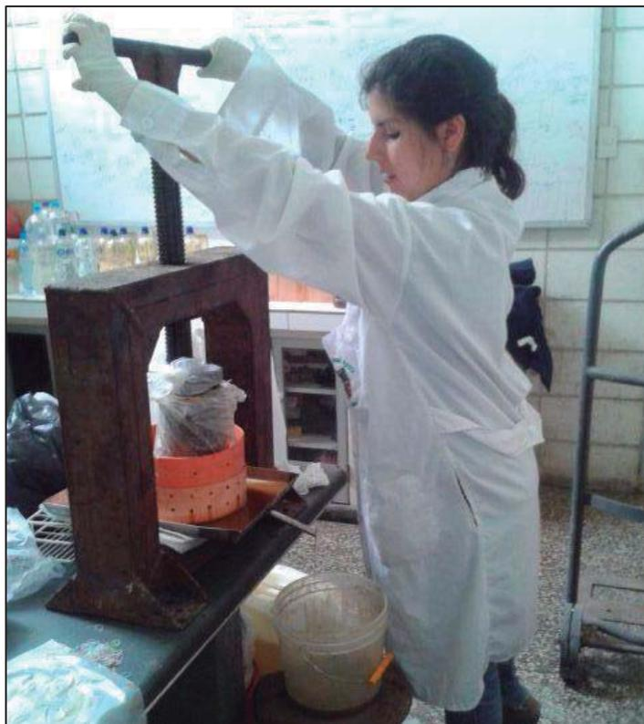
**Fotografía 7.** Prensado del biofertilizante
