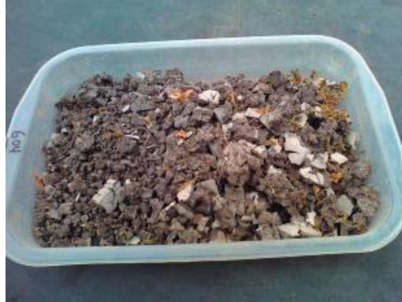
Figura 1: Lodos residuales de la planta de tratamiento de efluentes domésticos por aireación extendida (lodos activados).
