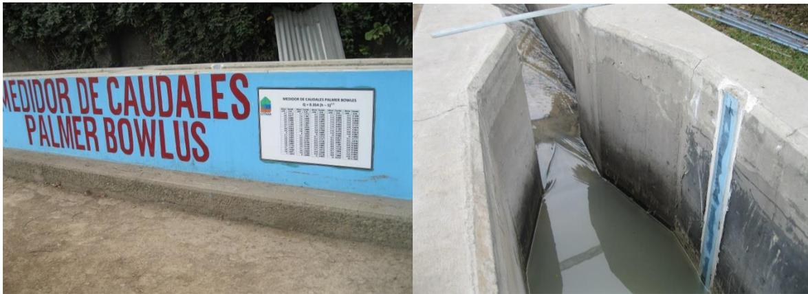
**Foto 8. Medidor de Caudales Palmer Bowlus. Sirve para medir caudales.**
