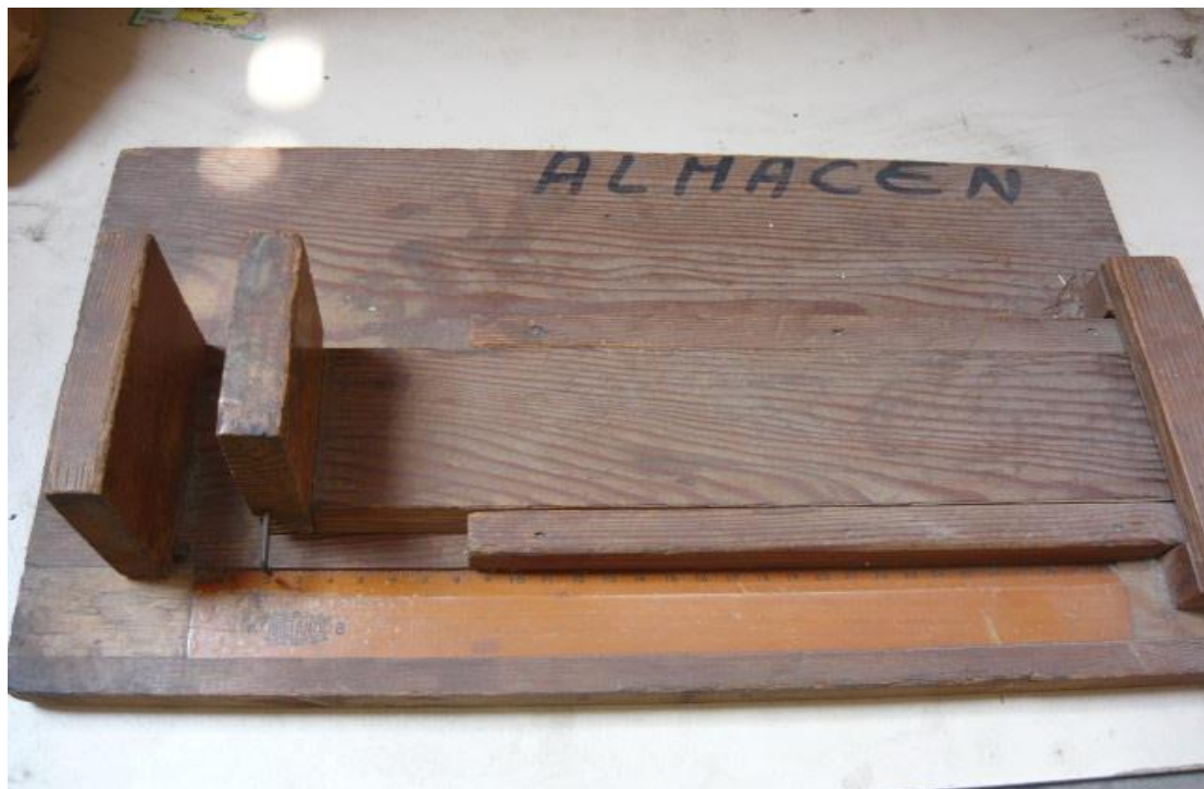
Figura 25: Dispositivo usado para medir longitud y diámetro de mazorca.
