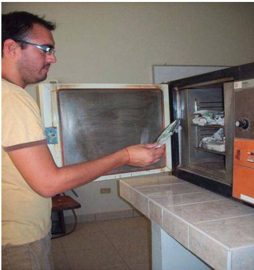
Figura 31: Secado de muestras en laboratorio
