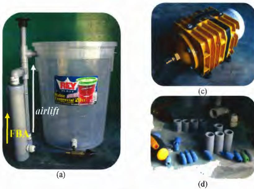
Figura 12. (a) Sistema *DENILIFT*; (b) diagrama de tuberías de un sistema *DENILIFT*; (c) compresor eléctrico empleado durante el ensayo; (d) difusores de cerámica acoplados a los mini-sistemas *airlift* [Fuente: propia].
