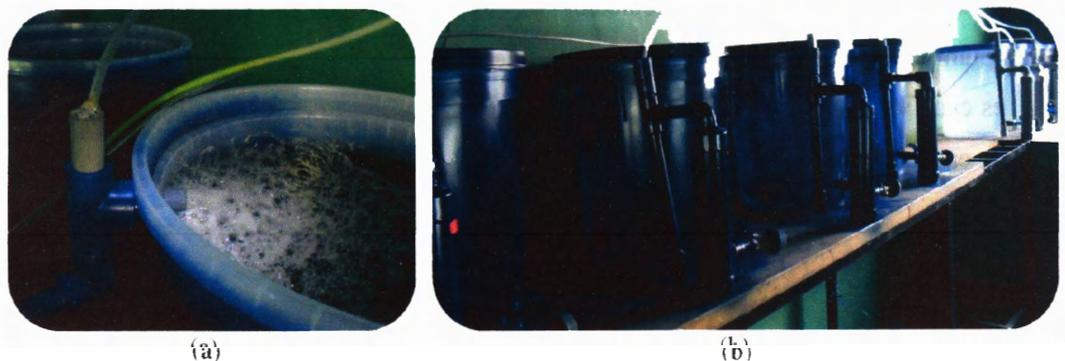
Figura 25. (a) Sistema *DENLIFT* produciendo espuma a la salida del *airlift*; la adaptación de una cámara de espuma sometida a presiones de vacío para recuperarla es una solución práctica a considerar; (b) Sistemas *DENLIFT* expuestos a un fotoperiodo 24h nocturno (a la izquierda) y a un fotoperiodo natural (a la derecha).
