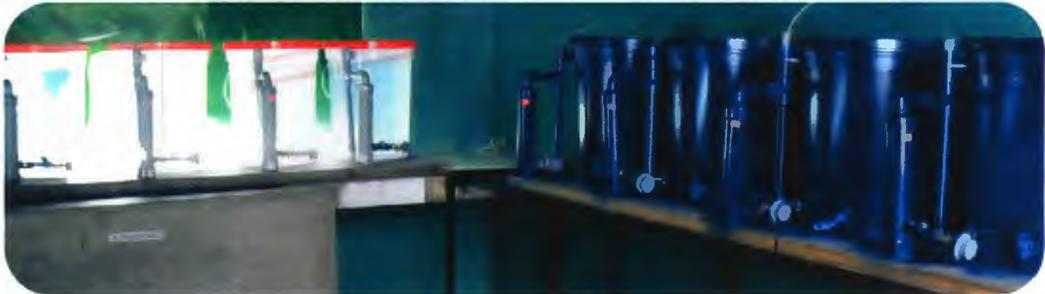
Figura 19. A la izquierda, 4 sistemas *DENILIFT* expuestos a un fotoperiodo 24 h diurno y a la derecha, 4 sistemas *DENILIFT* expuestos a un fotoperiodo 24h nocturno (Fuente: propia).
