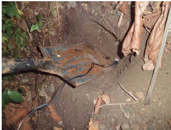
Figura 20 Instalación de los Bloques de yeso.
