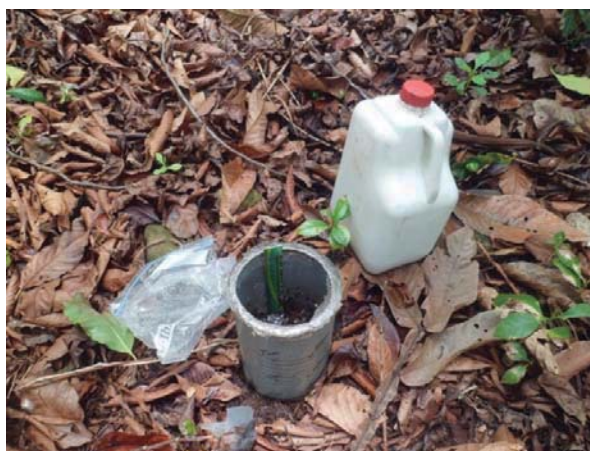
Figura 19 Instalación del cilindro infiltrómetro en campo.
