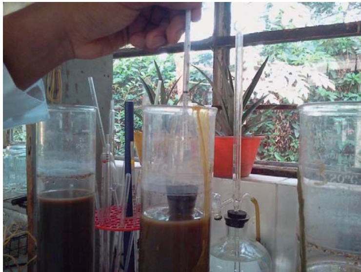
Figura 21 Medición con Hidrómetro.
