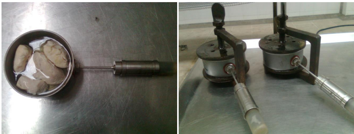
Figura 12: Mecanismo utilizado para asegurar que la punta de las sondas quedaron insertadas en las piezas de pollo.
