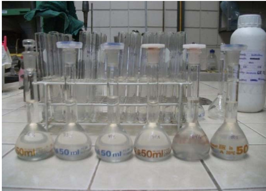
Figura 29: Concentraciones preparadas para el ensayo con Daphnia magna
