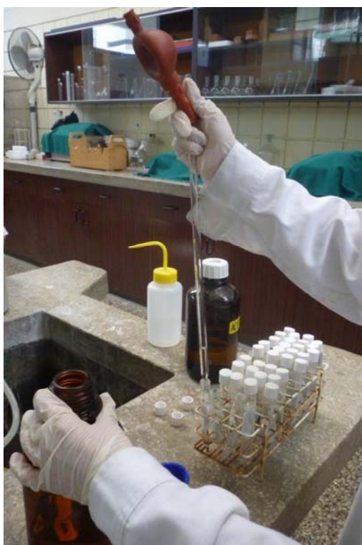
Figura 15: Colocación de sustancias químicas para la determinación de clorofila a
