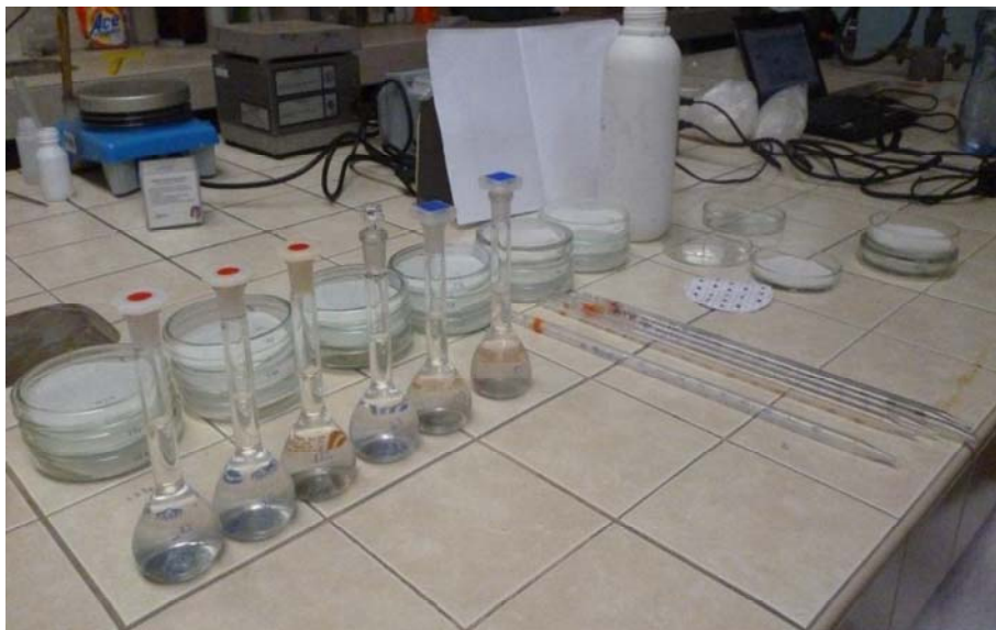
Figura 32: Materiales usados para el bioensayo con Lactuca sativa
