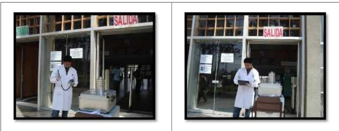
En las fotos se puede apreciar el momento de la toma de las muestras y medición de la temperatura ambiente y humedad relativa en la parte frontal de la BAN (Punto 1), en la foto adyacente se registra la información respectiva.
